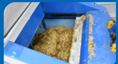
Der Stallmist wird mittels Pressstempel für eine maximale Auslastung komprimiert.
