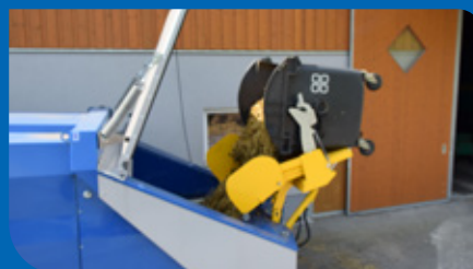
Entleerung des Mistbehälters mit automatischem Entleersystem.
