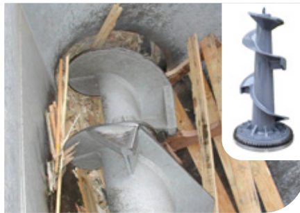
Holzschnecke zur effizienten Verarbeitung von Holzabfällen, wie ganzen Euro-Paletten
